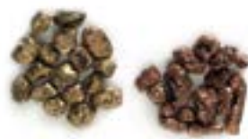
Beispiel für Gut- und Schlechtmuster für zu sortierende Granulate aus Messing und Kupfer
